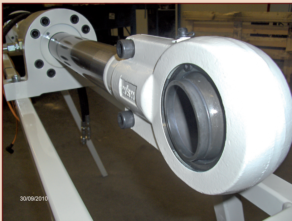
Cilinder van Uniparts Kavee voorzien van Lunac 2+ stangbekleding voor maritieme toepassingen.
